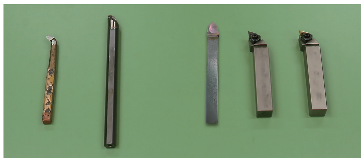
写真左から、面取りバイト 内径用（ハイス）、内径切削用バイト荒・仕上げ兼用（サーメット）、面取りバイト 外径用（ハイス）、外径切削用バイト仕上げ用（サーメット）、外径切削用バイト荒削り用（超硬）
